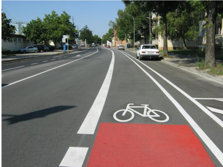
Bild 5 Radfahrstreifen mit markiertem Sicherheitstrennstreifen (Singen)
