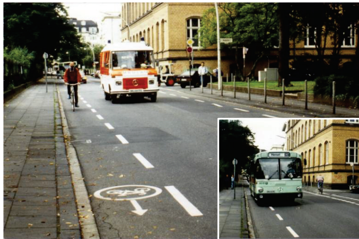
Bild 6 Schutzstreifen als Schonraum für Radfahrer und „Reservefläche“ für Großfahrzeuge (Bonn)
