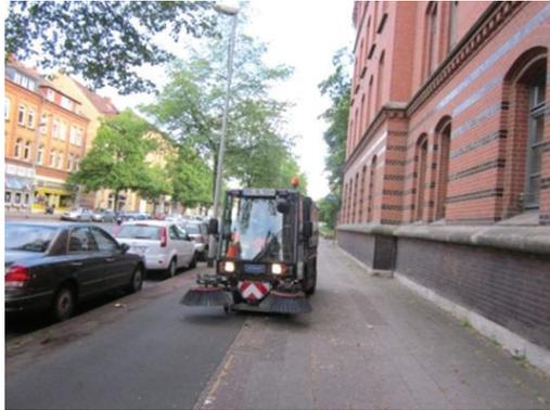
Bild 23: Kehmaschine für Radwege (Braunschweig)
