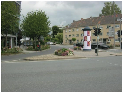
Bild 109: Querung der Hindenburgstraße über die Fußgänger-LSA und ungesicherte Rechtsabbiegefahrbahn
