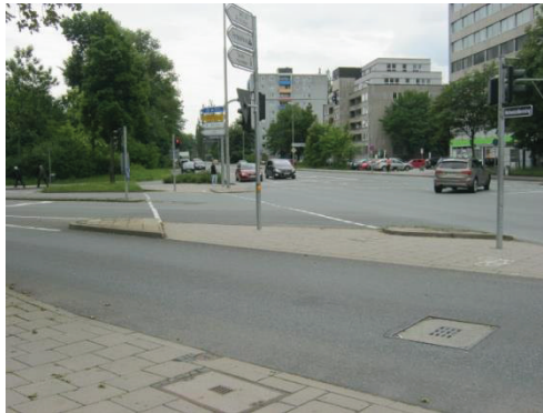
Bild 66: Ungesicherte Querung des nördlichen freien Rechts-abbiegers und geringe Aufstellfläche auf Dreiecksinsel
