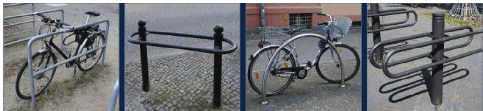
Bild 147: Beispiele für anforderungsgerechte Anlehnbügel (Potsdam)
