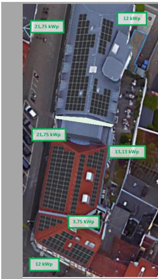
In der nebenstehenden Grafik sind die mit Photovoltaikmodulen belegbaren Flächen und der jeweiligen Leistung gekennzeichnet. Theoretisch lässt sich eine Gesamtanlagenleistung von 84 kWp installieren. Bei einem Stromverbrauch von über 400.000 kWh jährlich, stellt sich nicht die Frage, ob eine PV-Anlage sinnvoll ist und in welcher Größe diese ausgeführt werden sollte. Hier müssen alle Dachflächen - sofern statisch machbar - vollständig mit Photovoltaikmodulen belegt werden!
