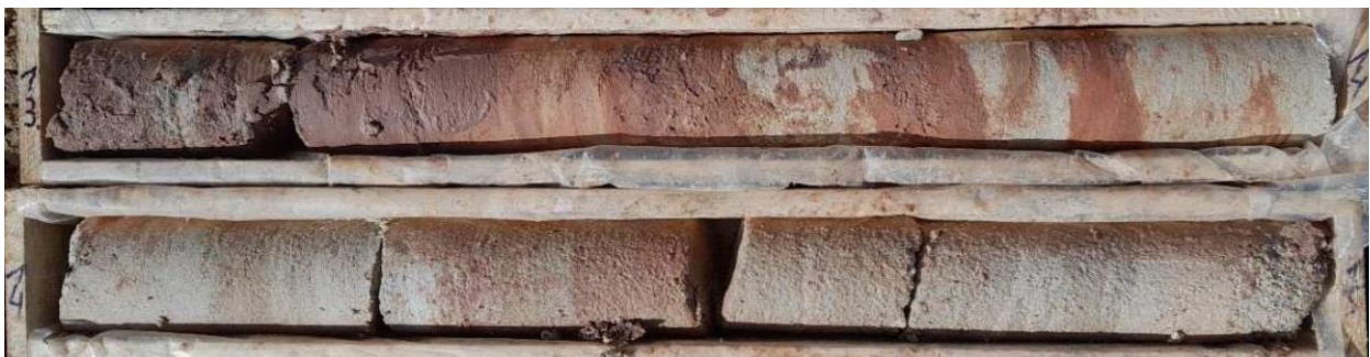
Abb. 4-3: Charakteristisches Material „Sandstein mit vereinzelt dünnbankigen Ton- /Tonsteinlagen“
