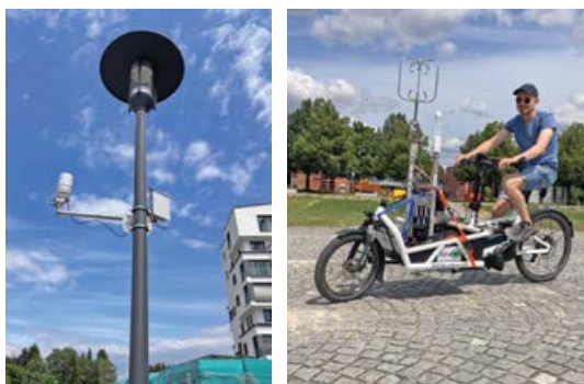
Abbildung 18: Stationäre Mikro- Klimamessstation an Laterne und mobiles Fahrradmesssystem.
