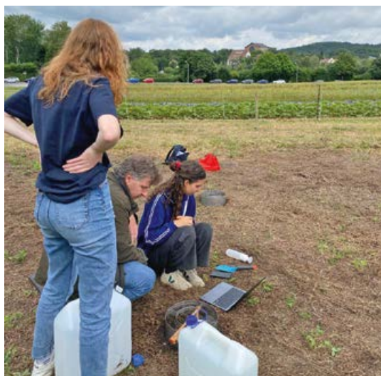
Abbildung 21: Messung mit einem Doppelringinfiltrometer
